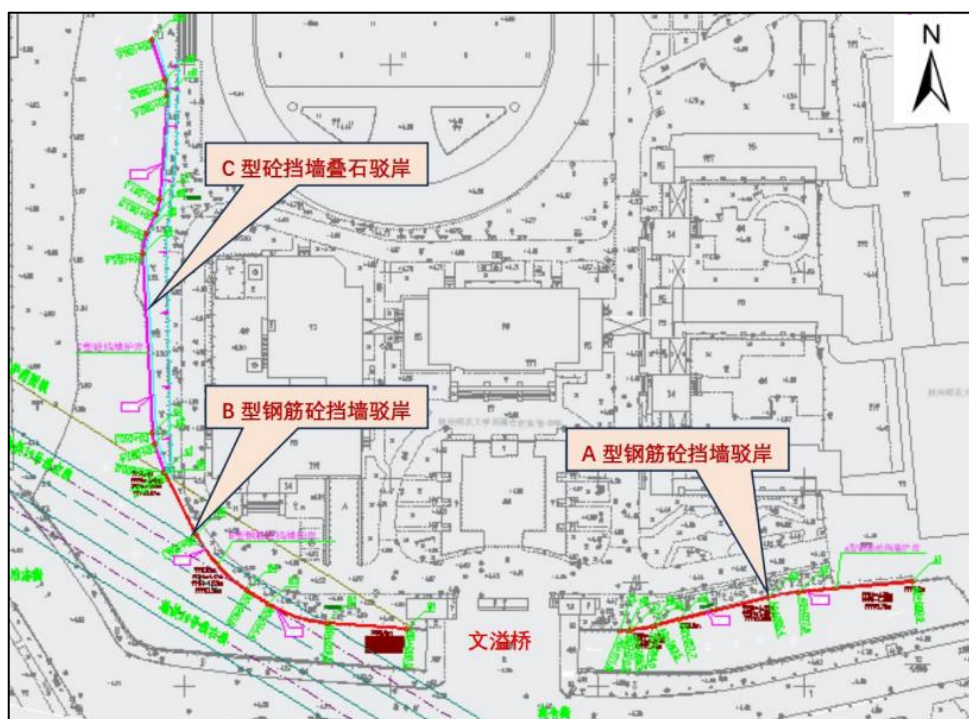
图 2-1 挡墙加固岸线布置平面图
