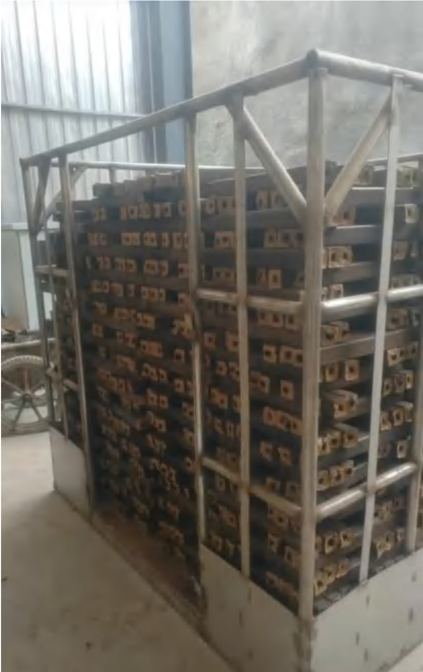
图 2-3 同类型企业吊装炭化窑吊篮示例图（单个）
