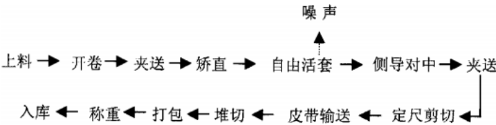
图 3-2 冷轧钢板件生产工艺
