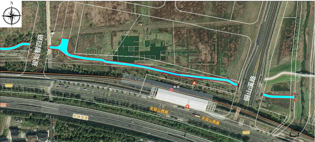
图 2-1 护城河（铜山溪至智四路）堤线布置
