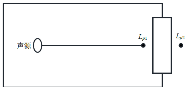
图17 室内声源等效为室外声源图例
