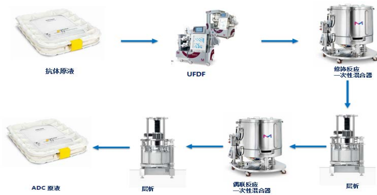
图 13 ADC 原液研发工艺设备示意图
