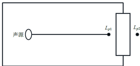
图8 室内声源等效为室外声源图例
