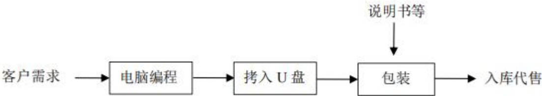
图 3-20 软件生产工艺及排污节点图
