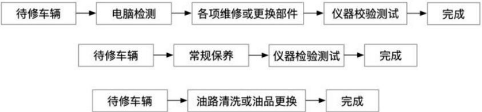
图 3-34 修理工艺流程图
