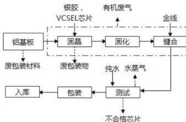
图 3-25 COB 铝板产品封装工艺流程图
