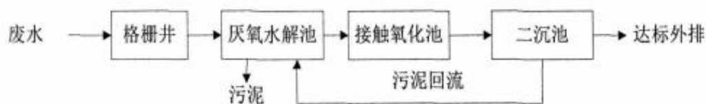
图4-1 污水处理站处理工艺
