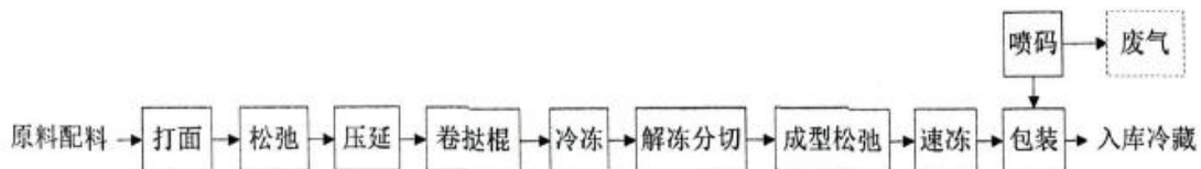
图 2-7 挞皮生产工艺流程图
