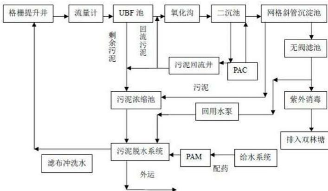
图 4-2 双林污水处理厂工艺流程图
