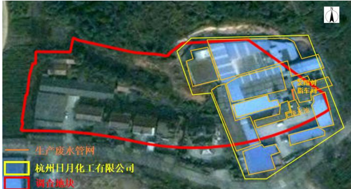
图 3-23 地块内污水管线分布图
