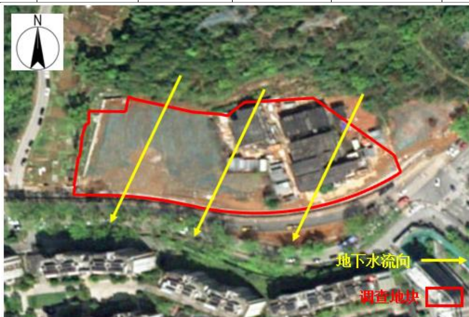
图 3-9 调查地块所在区域地下水流向示意图
