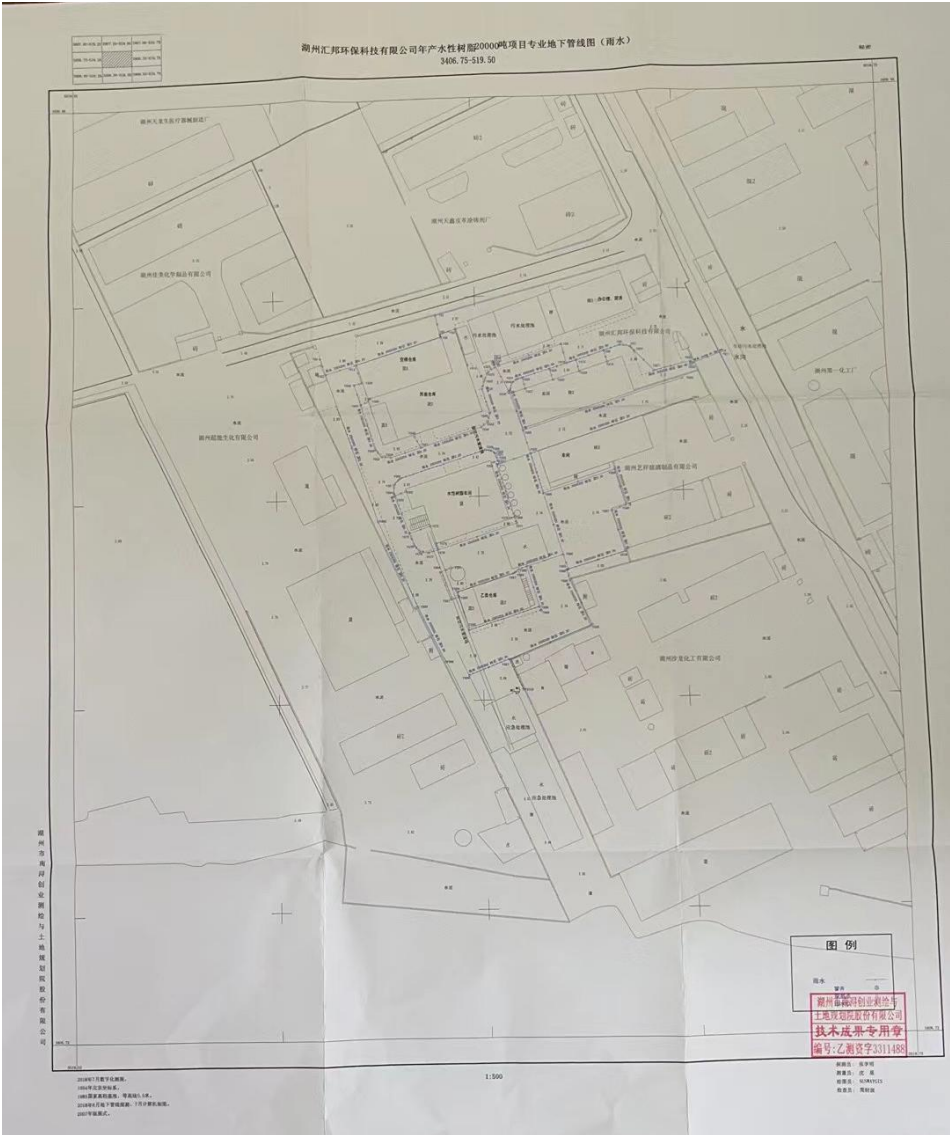
图 4.3-2 厂区雨水管网测绘图
