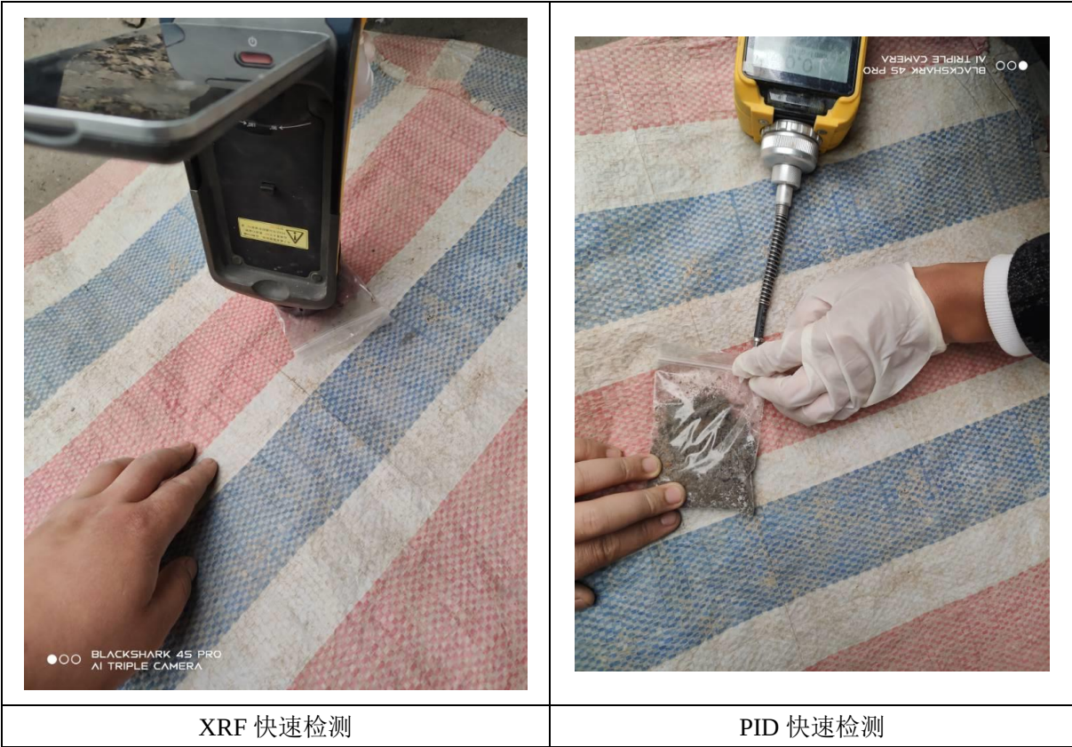
图5-1 部分点位现场检测照片
