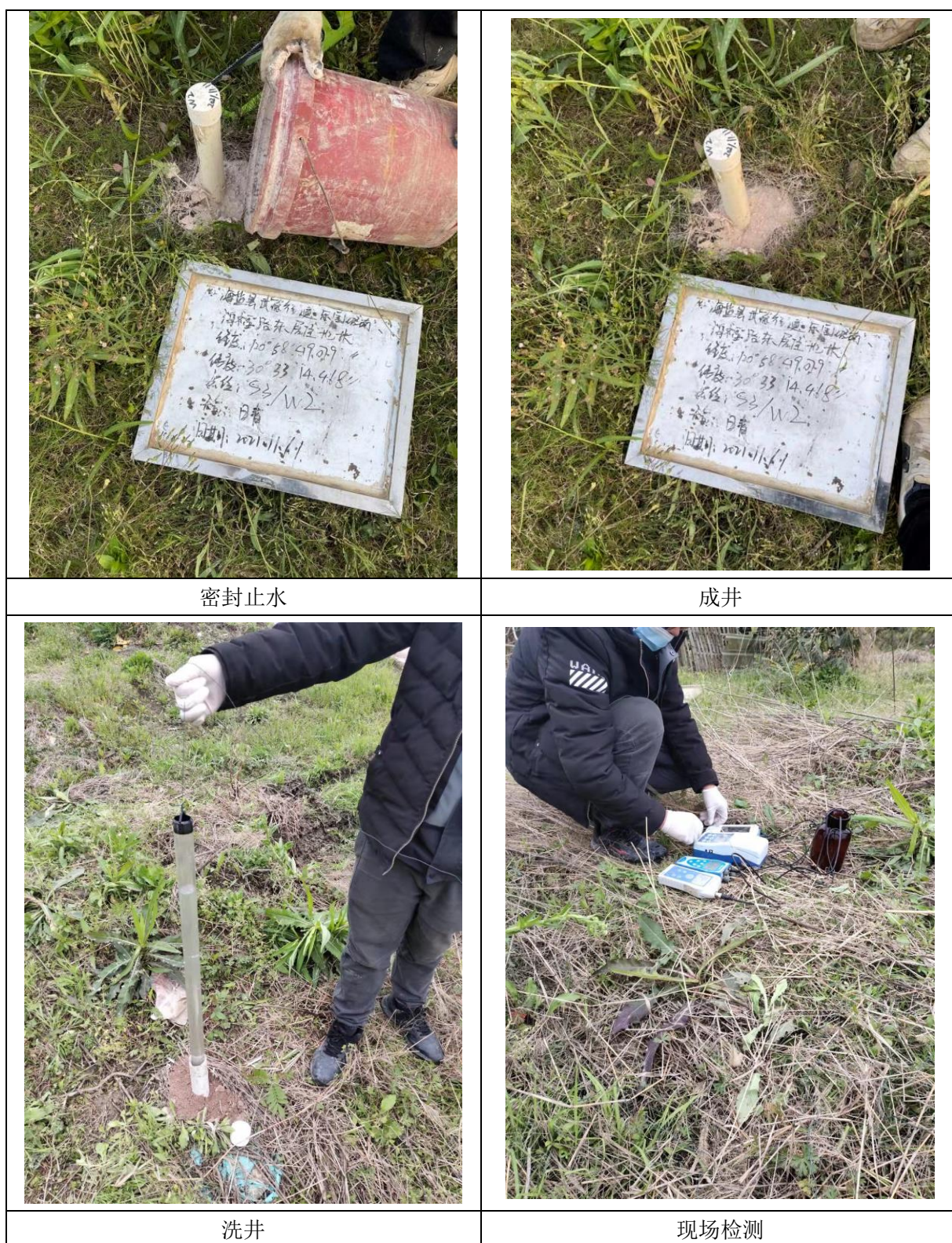
图5-5 部分地下水建井、洗井、检测照片
