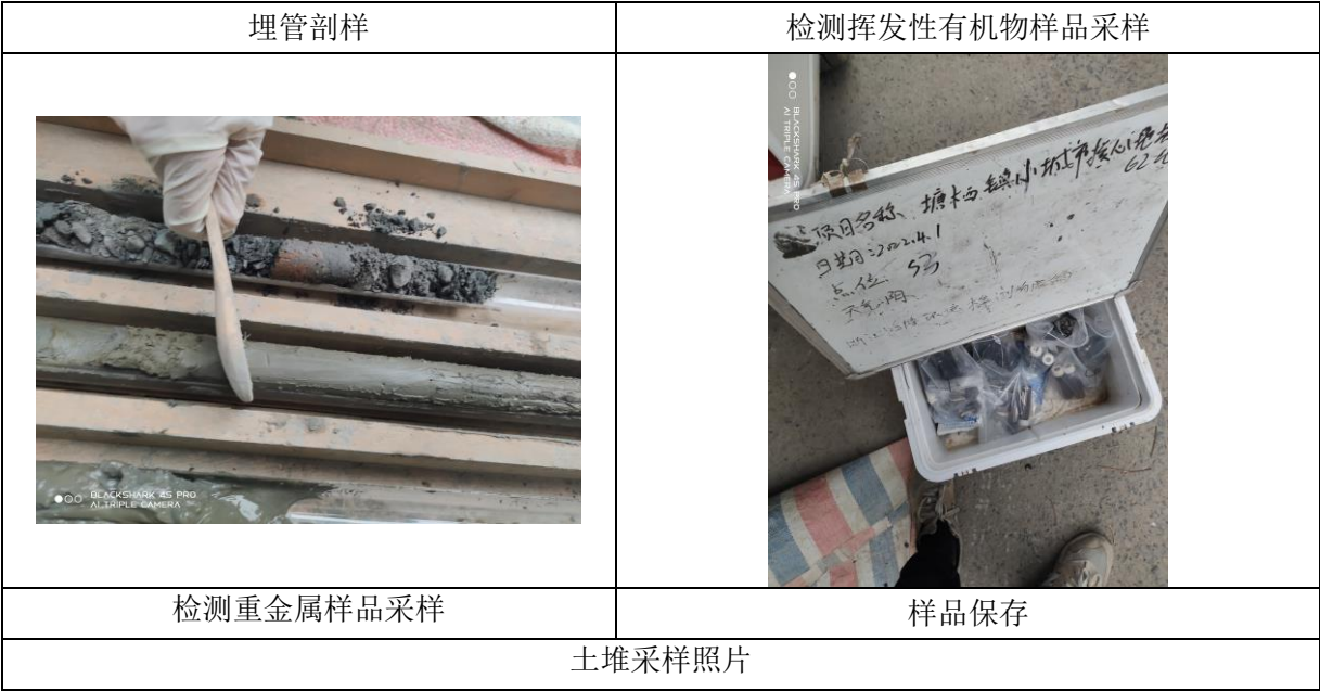
图5-3 部分土壤采样照片
