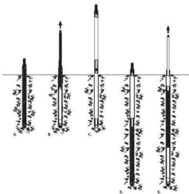
图5-2 土壤钻探取样示意图
