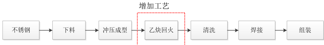
图 2-15 乙炔回火工艺流程图
