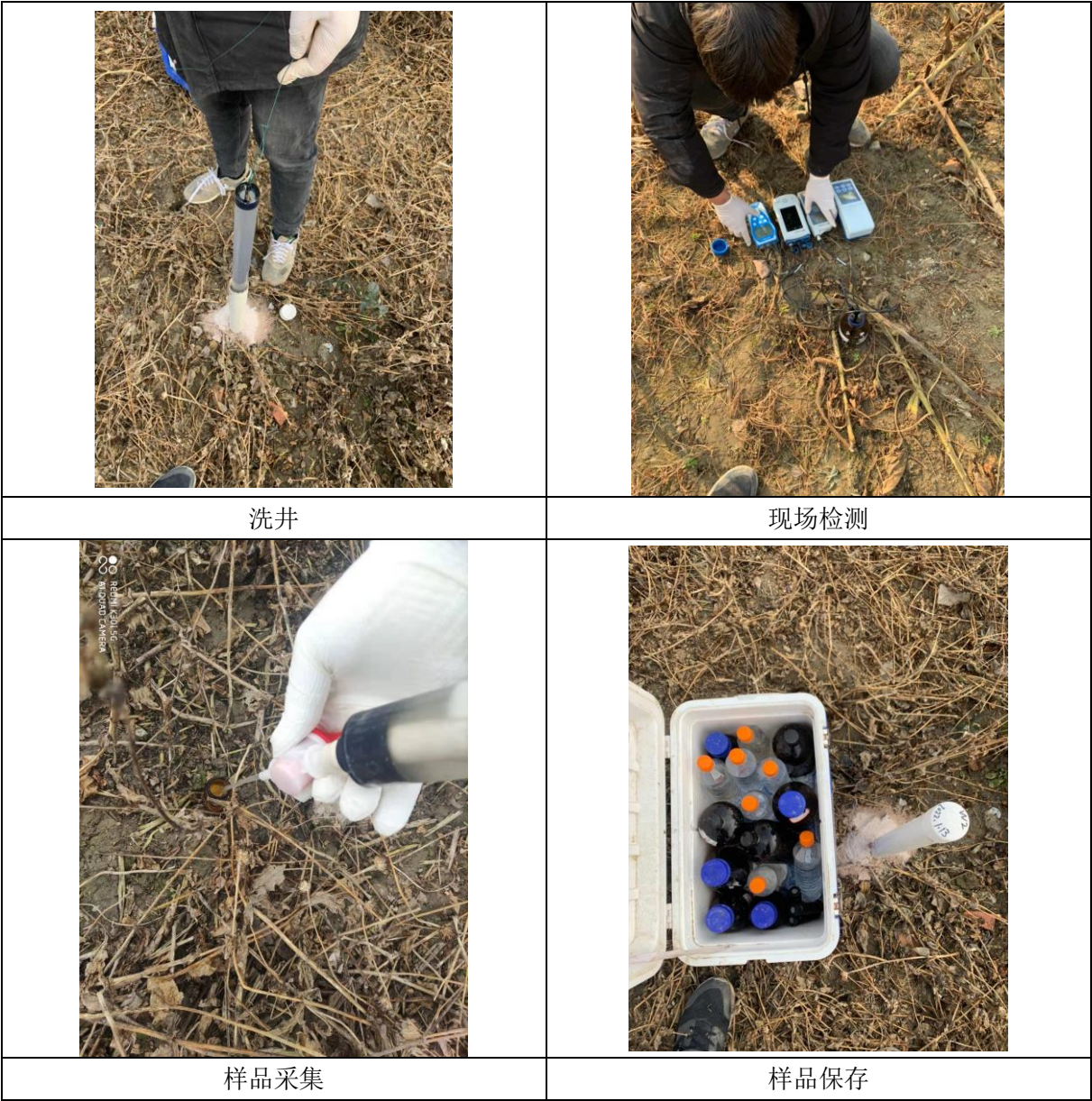
图5-5 部分地下水建井、洗井、检测照片
