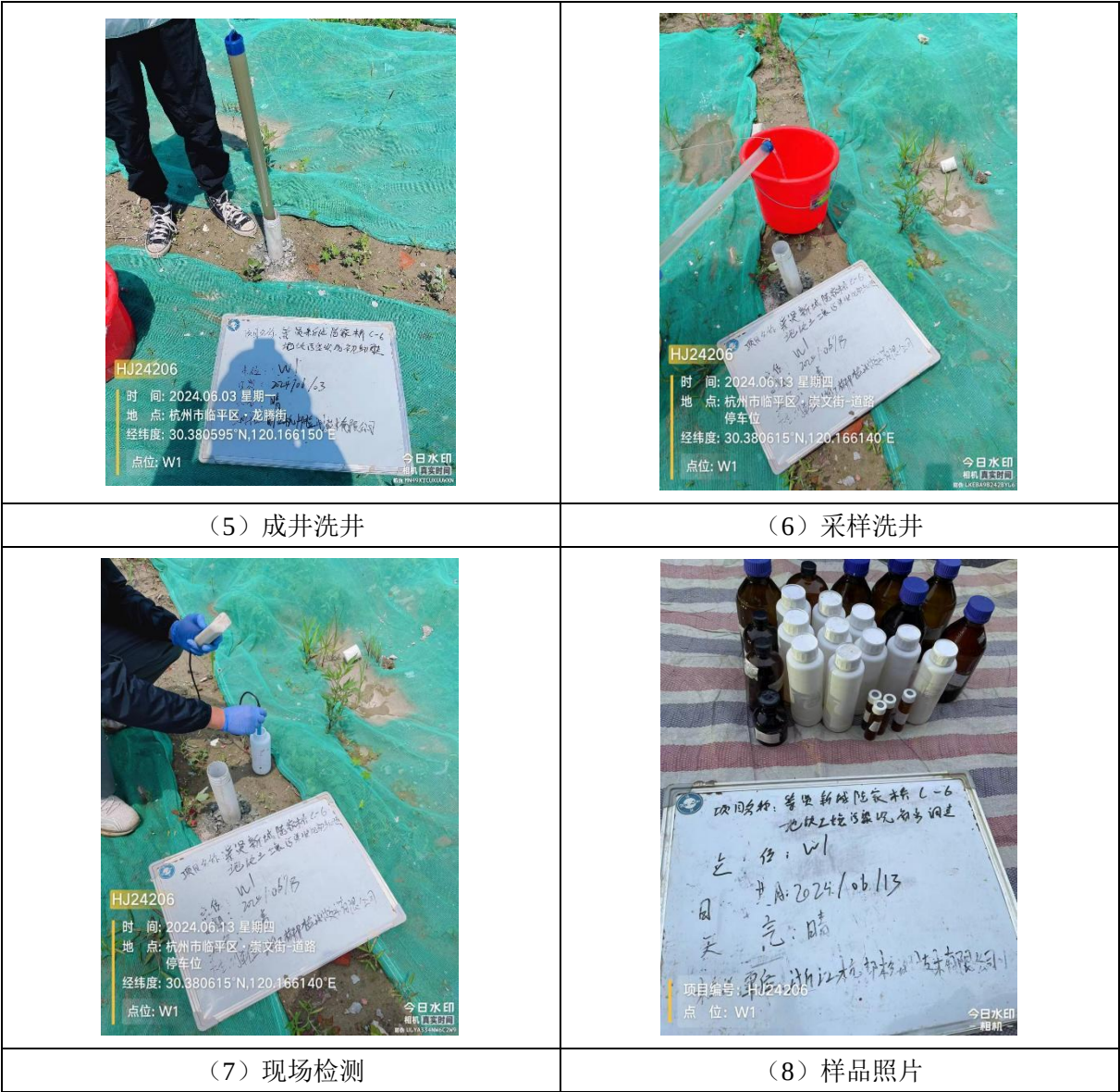
图5-3 部分地下水建井、洗井、检测照片
