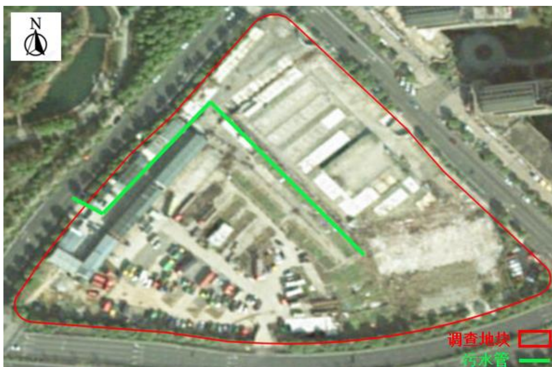
图3-16 本次调查地块作为项目部使用时污水管分布示意图
