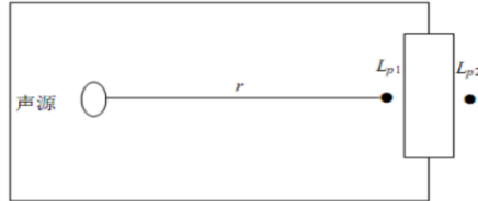
图 4-1 室内声源等效为室外声源图
