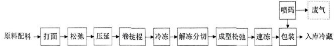
图2-15 全烤蛋挞生产工艺流程图
