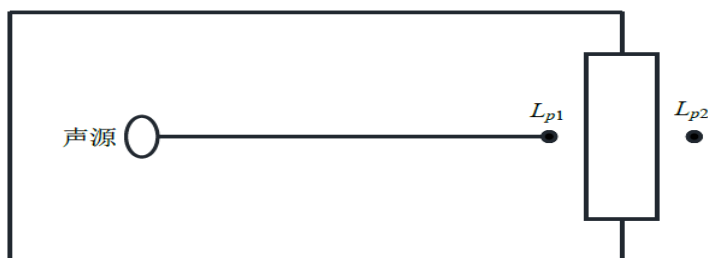
图4 室内声源等效为室外声源图例
