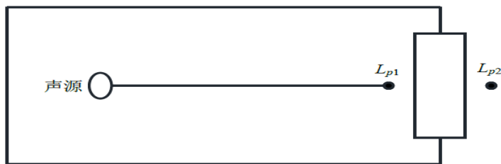
图7 室内声源等效为室外声源图例
