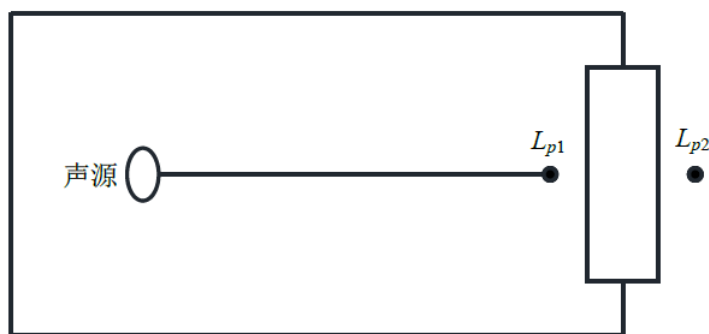
图 4-3 室内声源等效为室外声源图例
