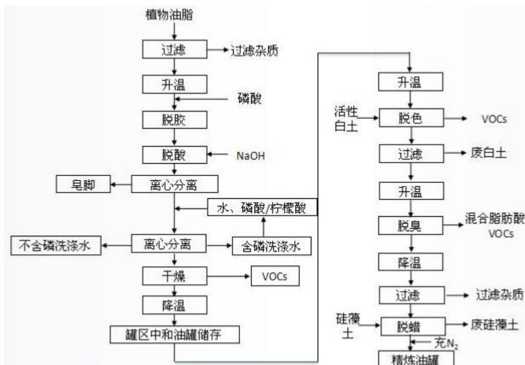
图 2-11 植物油精炼生产工艺流程图
